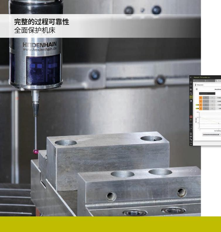
TNC7提供新一代DCM(动态碰撞监测)功能。DCM不仅可以避免机床部件与刀具间的碰撞。TNC7还可导入3D文件格式的夹具,监测夹具,全新循环可在图形支持下轻松找正夹具。
