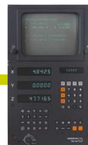
1981: TNC 145, первое контурное ЧПУ компании HEIDENHAIN
