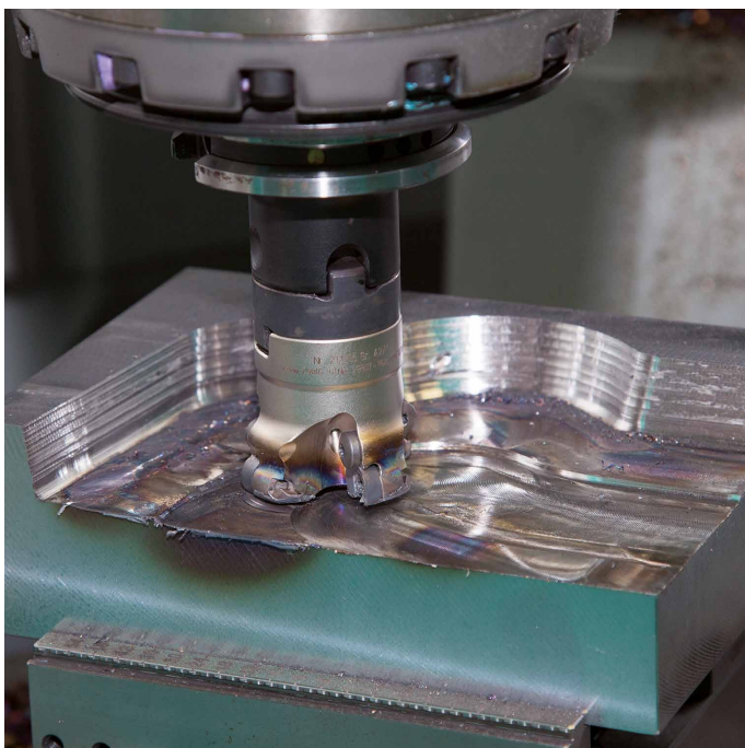
破损的可转位刀片可造成工件次生损坏
