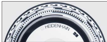
Konvenční optický kotouč se 13 stopami Grayova kódu
